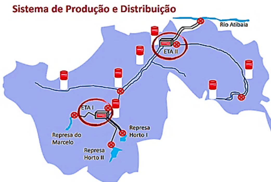
Figura 218 – Sistema de produção e distribuição de água
